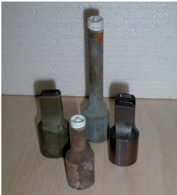
Bild 5: Emaillierte Titansonotrode.
