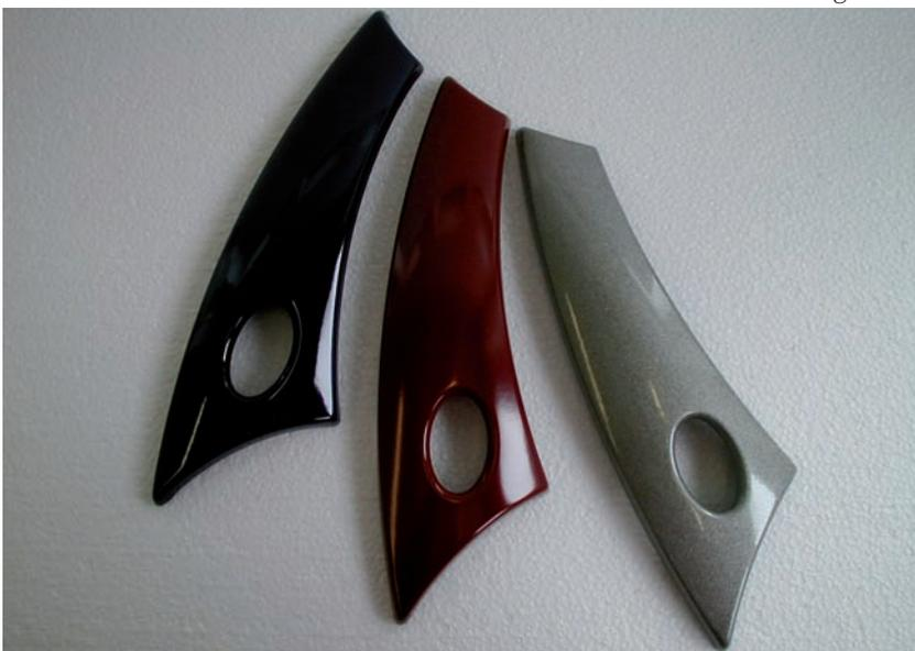
Bild 1: Emaillierte Schmiedeteile aus Aluminiumblech AlMn1.
